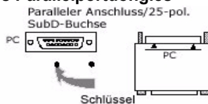
Abbildung 2 Anschluss des Dongles an den Parallelport Ihres Computers
